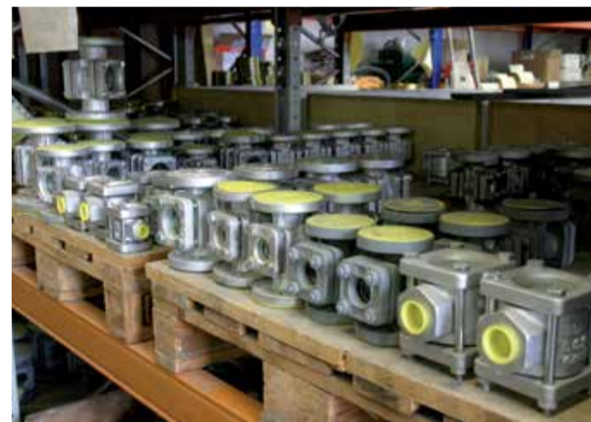
Ein Teil der Schaugläser aus dem Lager
