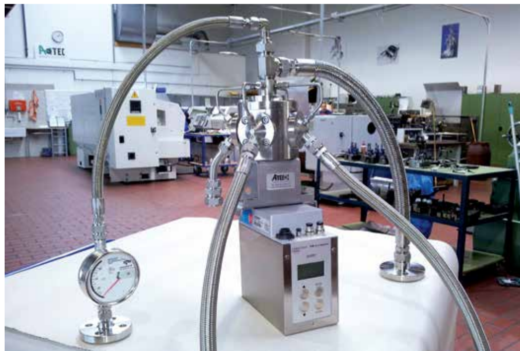
Der Fünf-Wege-Kugelhahn von ATEC trägt zum Umweltschutz bei
