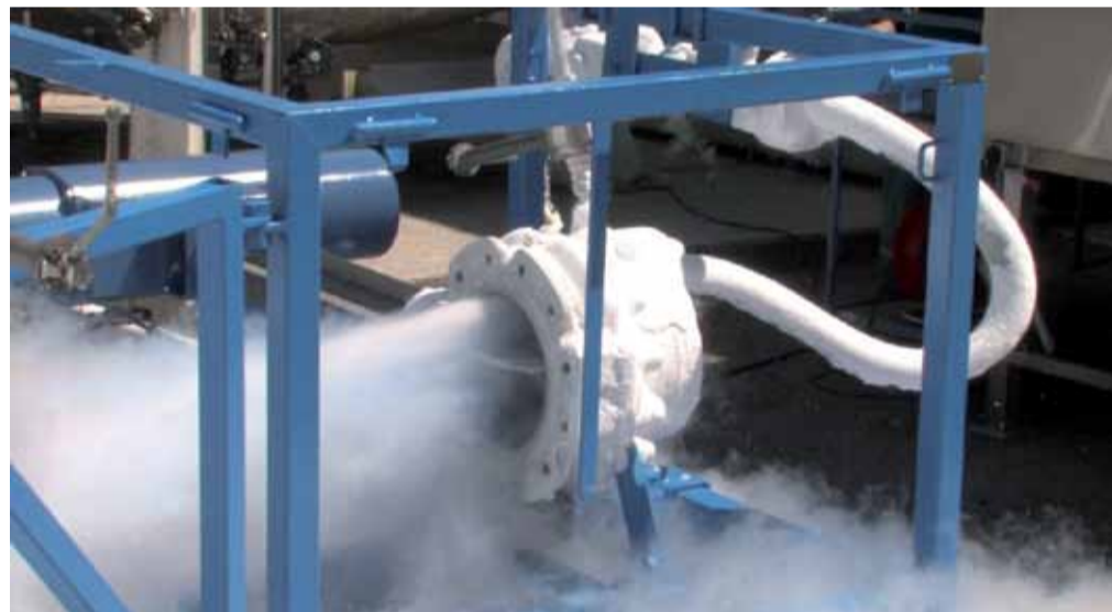
Das Testlabor in Horgau bietet die Möglichkeit, Klappen in bis zu -273° C kaltes Nitrogen zu tauchen und damit die Tauglichkeit für den Einsatz in Tieftemperaturanwendungen nachzuweisen.
