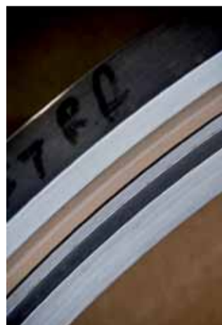
Detail eines Sitzringes mit Peekdichtung
