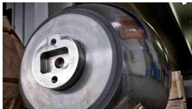
Das fertige Produkt: eine einbaufertige Kugel für einen 40-Zoll-Kugelhahn
