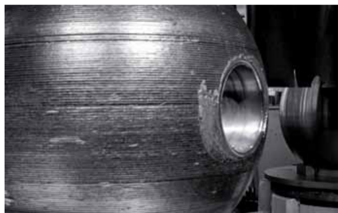
Eine aufgeschweißte Kugel bei dem ersten Schritt der Nachbearbeitung
