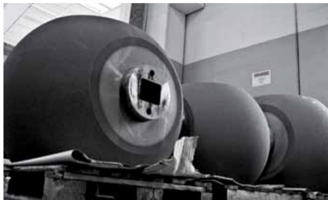
Mit Wolframkarbid beschichtete Kugeln vor dem letzten Bearbeitungsschritt
