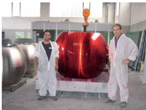
Vorbereitung zur Farbeindringprüfung nach Aufschweißen und Schleifen einer Kugel
