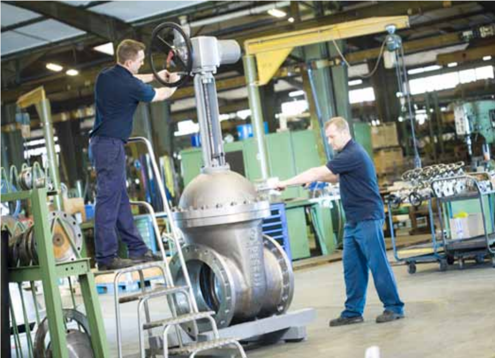
Montage eines Schieber DN 500 PN 25 mit Elektrostellantrieb.
