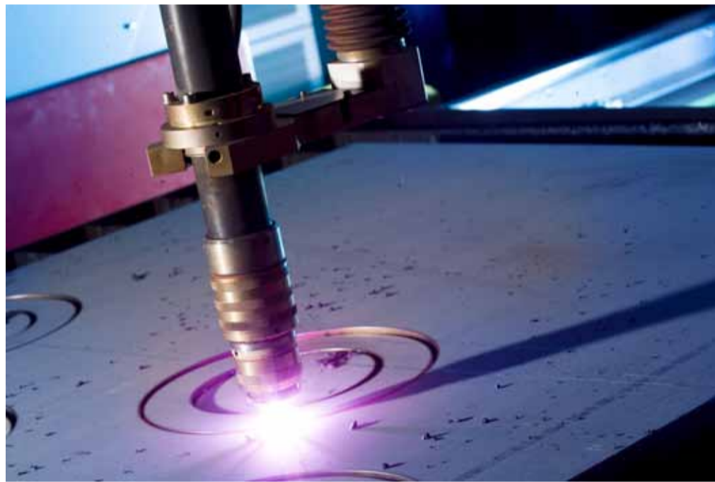
Die Plasmaschneidemaschine bei der Arbeit.
