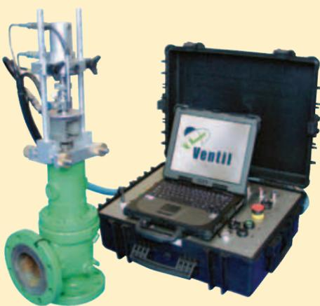
Beim PreVenTest „In-Situ“ Prüfsystem für Sicherheitsventile erübrigt sich eine Abschaltung der Anlage
