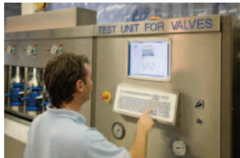
Computerkontrolle für die vollautomatische Testsequenz – ohne Eingriff durch den Bediener.
