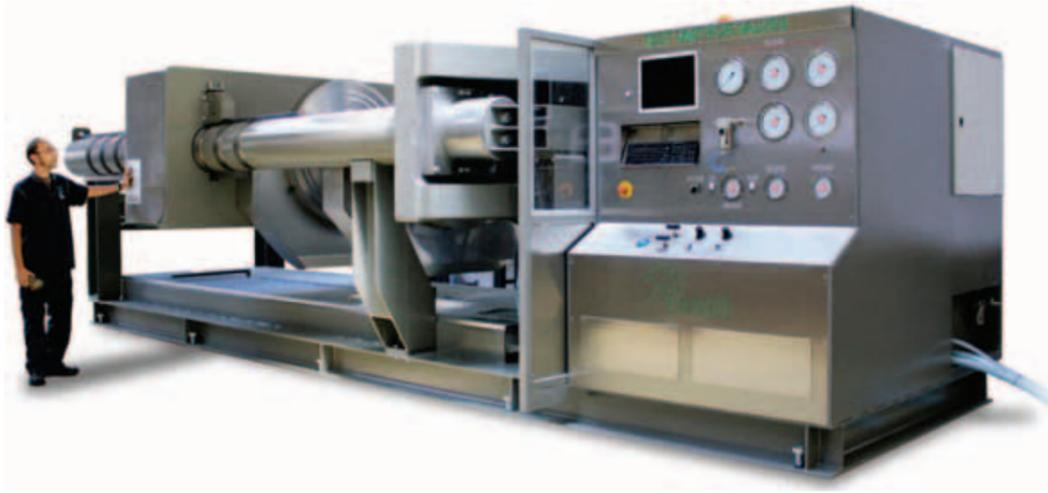
Prüfstand HC2000-CR für Hochdruck Shut-Off und Steuerventile DN200 – 1000 mm / 8 - 40"
