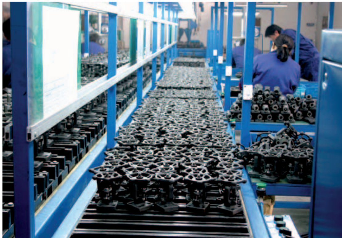
Dies ist die Fertigungslinie für geschmiedete Armaturen
