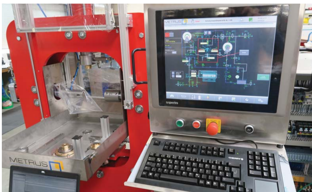
Das Portfolio bei METRUS reicht vom kleinsten Prüfstand bis hin zum Prüfautomaten mit über 100.000 Schaltspielen pro Jahr oder Wasserprüfungen mit 1.600 bar. Foto: METRUS
