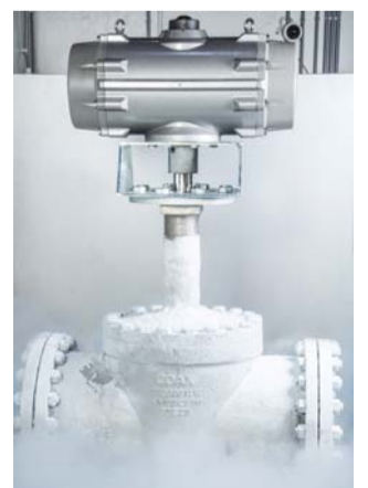
Die QUADAX® 4-fach-exzentrische Klappe übertrifft die Zielwerte eines anspruchsvollen thermischen Dauertests und liefert damit den Beweis für ihre Qualität und Zuverlässigkeit in LNG-Anlagen. Foto: müller coax group
