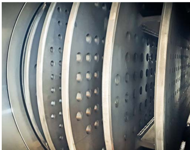
Der Velan ABV Key-C Kugelhahn mit Drehsteuerung ist mit einer speziellen Käfigverkleidung ausgestattet. Die Key-C-Trim-Geometrie minimiert den Druck an der Vena contracta im Inneren des Ventils und gewährleistet einen sehr hohen Druckausgleichsfaktor über den gesamten Hub des Ventils. Foto: Velan
