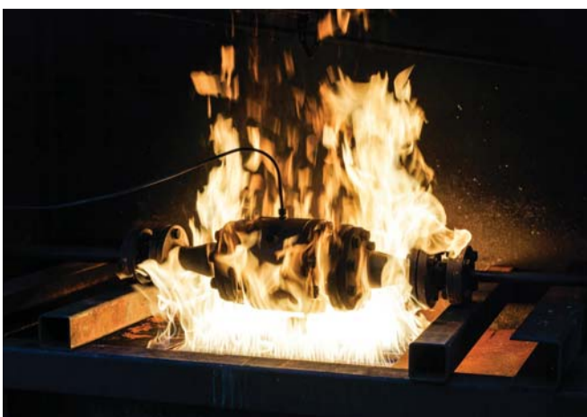
Fire-Safe Tests gehören bei vielen Hochleistungsarmaturen zum Standard.
