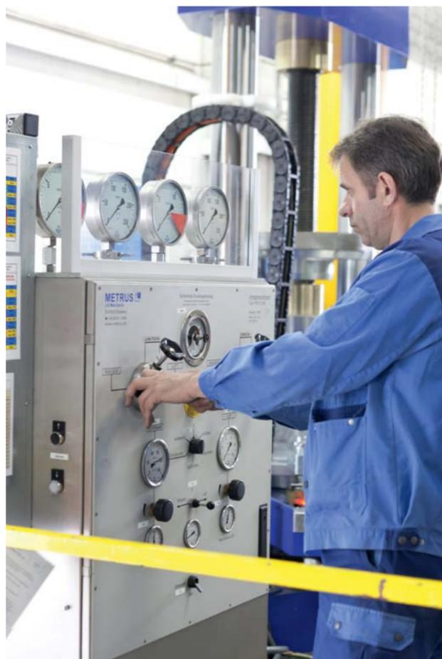
Druck- und Dichtigkeitsprüfung nach Wareneingang
