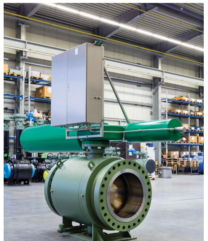
Schnell dicht: Sicherheits Absperrereinheit (SAE) in Nennweite DN 700 nach EN 14382. Der Kugelhahn benötigt 2 Sekunden für den Schließvorgang - Böhmer ist das einzige Unternehmen, das in Deutschland die Zulassung für dieses System hat
