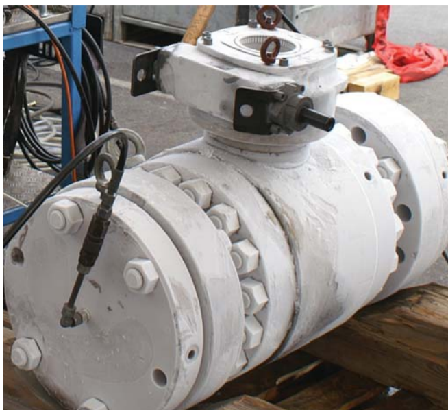
Tiefemperaturtests gehören bei einigen Hochleistungsarmaturen zum Standard
