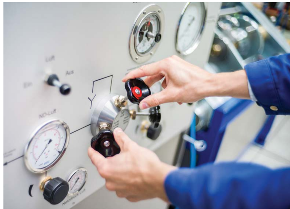
Lediglich die Kraft von drei Fingern benötigt das Nadelventil, um bis zu 600 bar perfekt abzudichten
