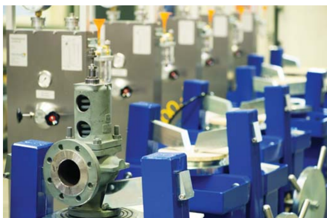
Der SVM 20 eignet sich für den Einsatz in mobilen Werkstätten, bzw. als „Terminal“ in Verbindung mit einer zentralen Druckversorgung für mehrere Prüfstände (Quelle (5): METRUS GmbH)
