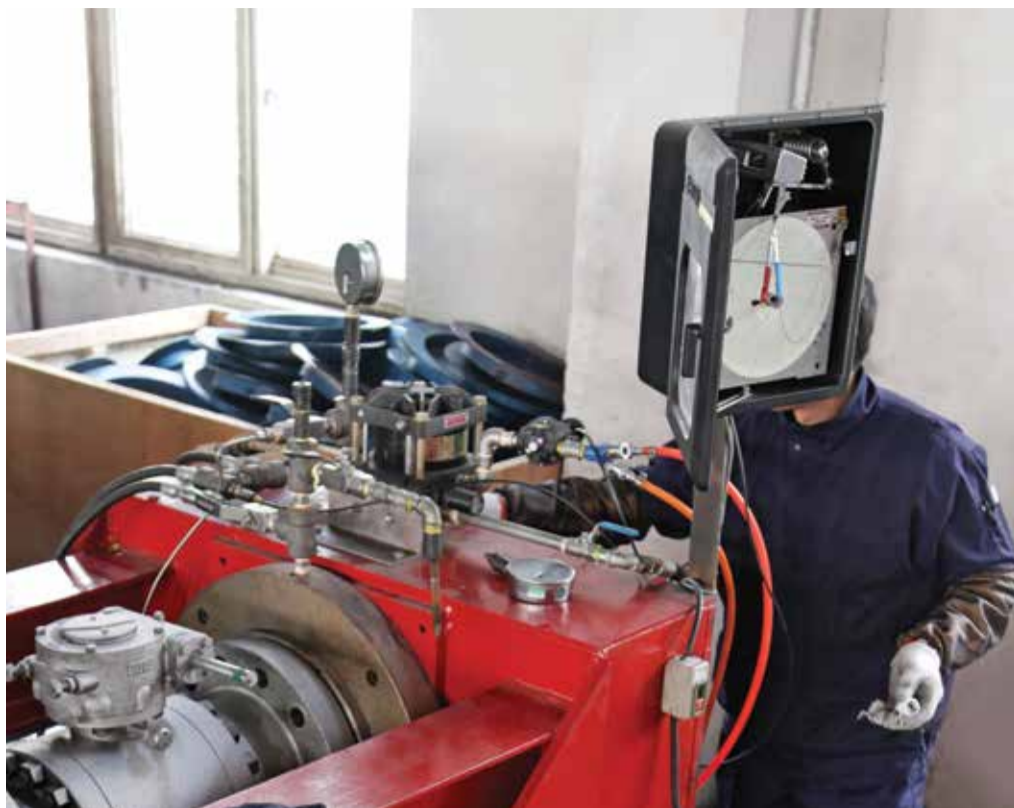
Durchführung und Aufnahme einer Druckprüfung
