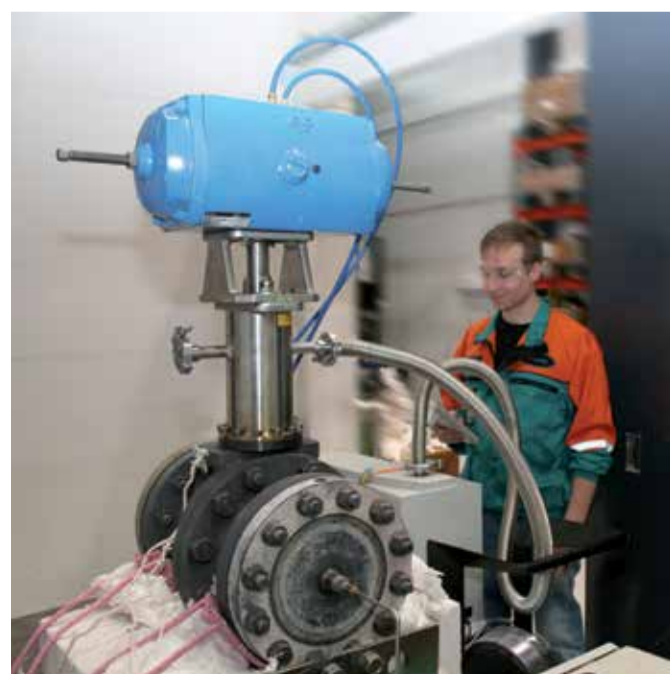
Neles T5 Top-Entry Drehstellventil mit intelligentem Ventil-Stellungsregler ND9000
