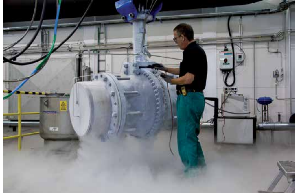
Test eines Kugelhahns im Metso Valve Technology Center in Helsinki
